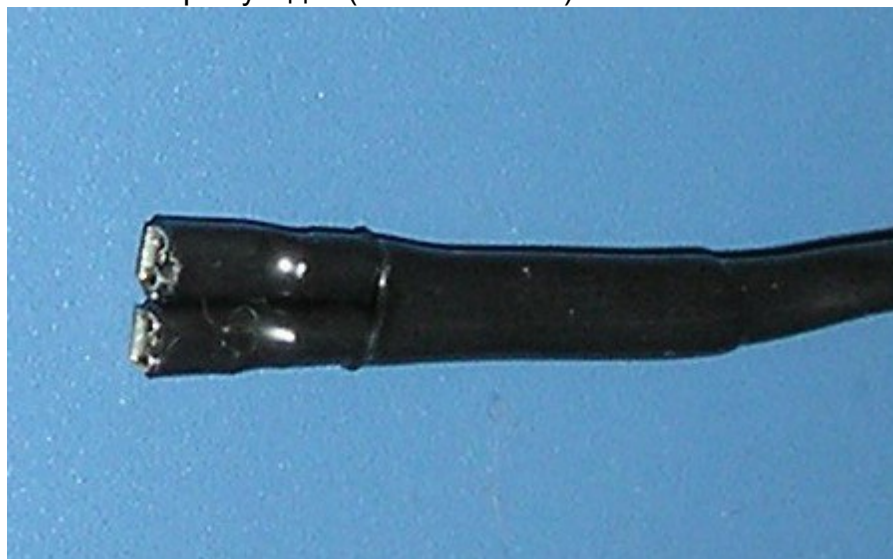
Клеммы в термоусадке (без колпачков)
